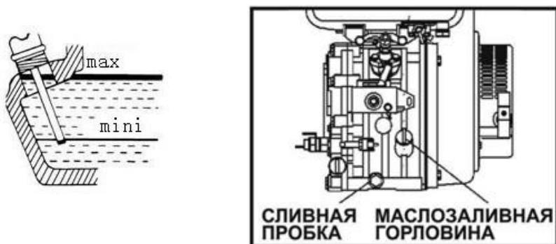
Тип масла: При использовании генератора в теплых условиях (от +10°C) мы рекомендуем SAE 10W30. При использовании генератора при низких температурах (ниже 0°C), рекомендованное масло SAE 10W40
